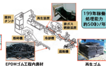
図2 再生ゴム製造プラントの例 —豊田合成(株)
