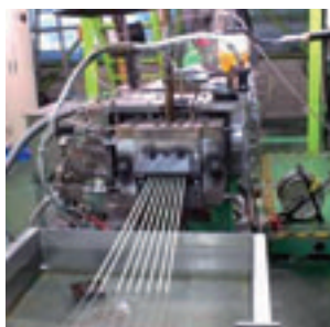
図-1 二軸押出機による製造状況
